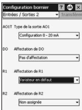
Konfigurace poruchového relé pomocí softwaru PowerSuite pro PDA
