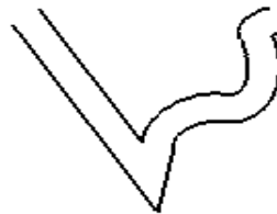
Ofset, kdy vnitřní úhel je větší než Offset Corner Angle (Ofsetový Úhel Rohu)
