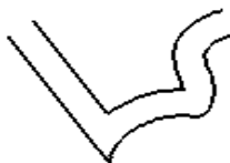
Ofsety směrem k vnitřní straně úhlu protnutí
