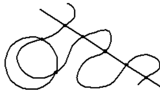
Přerušení spline křivky do 8 entit s příkazem AutoBreak (AutoPřerušení)
