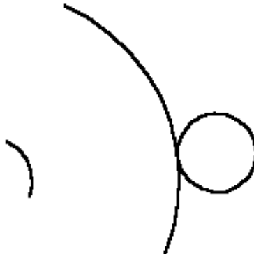
Oblouk použitím tečného oblouku Offset (Ofset) — Tangent (Tečnost)
