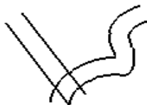
Napojené prvky k provedení ofsetu
