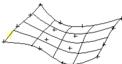
Plocha vytvořená použitím Interpolated Points (Interpolační Body)
