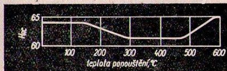
Obr. 10. Vliv teploty popouštění na tvrdost oceli 19 855 (Poldi Maximum Special 55) kalené při 1300 °C [8] ( H_{RC} tvrdost po popouštění)
