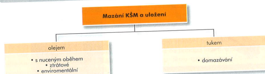
Obr. 5.142. Způsoby mazání kuličkového šroubu a jeho komponentů.
