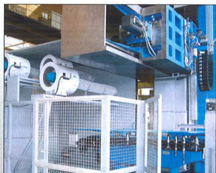
Obr. 5.230. Odsávací zařízení a ochranné ploty [TOSHULIN]
