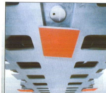
Obr. 6.43. Tříbodové ustavení DMC 340 U [DMG]
