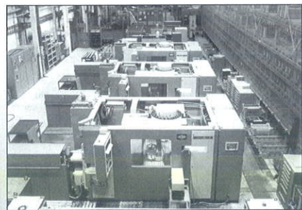
Obr. 6.49. MCSY – první multifunkční obráběcí centrum na světě [Kovosvit Mas]
