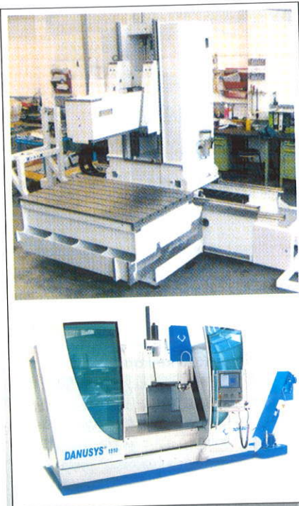
Obr. 7.1. Koncepce stroje pro vrtání a frézování Danusys [Donau]
