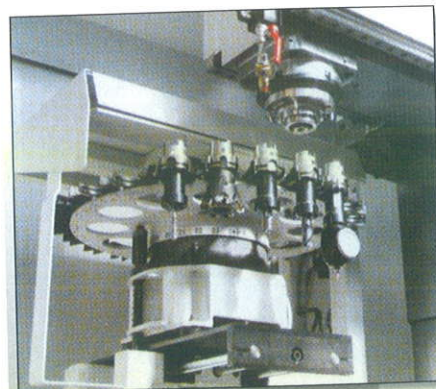
Obr. 7.2. Výměna nástrojů Pick-Up u stroje Danusys [Donau]
