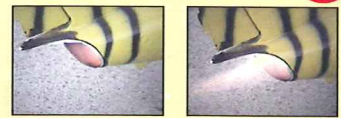
Výfuková roura musí zajistit ochranu konstrukce trupu před vysokou teplotou spalin, v tomto případě asi 900 °C při startování
