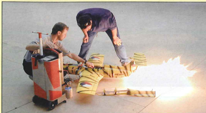
Pokud se při ručním řízení startu neopatrně zachází s plynovou pákou, dochází k takovýmto ohnivým efektům. Zášleh je ale krátký, ani na dřevěné podlaze pod modelem nezůstaly stopy po ohni.
