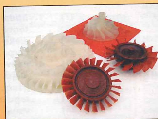
Obr. 16: Modely pro odlitky turbínového kola. Červené jsou pro lití horkých částí metodou ztraceného vosku z Inconelu, průsvitné slouží k výrobě sádrových forem pro části kompresoru z hliníku
