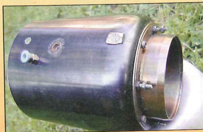
Obr. 15: Plášť spalovací komory a turbínového kola – zhotoveno z bomby na plyn, doplňky z nerez
