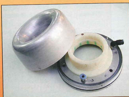
Obr. 14: Nasávací hrdlo z duralu a silonu, vývodky jsou na přívod paliva a oleje, přední kryt vytlačený z hliníkového plechu
