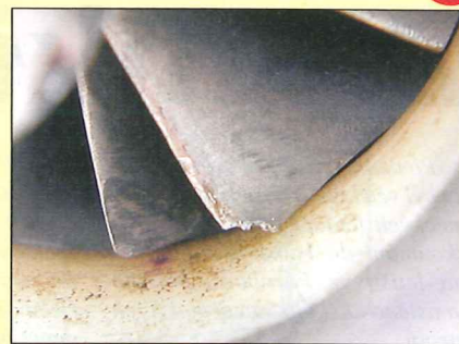
Obr. 24: Kompresorové kolo poškozené nasátými nečistotami
