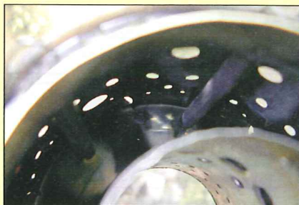
Obr. 20: Pohled odzadu do spalovací komory na odpařovací trubice – tam, kde směs paliva hoří, je povrch kovu čistý, kolem je pokrytý sazemi
