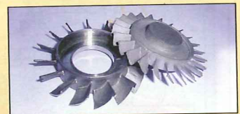
Obr. 17: Částečně opracované odlitky z Inconelu – vlevo rozvaděč, vpravo turbína
