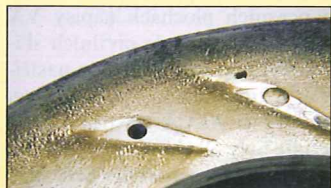
Obr. 21: Znečištění vnitřní části pláště kompresoru prachem po třech hodinách provozu
