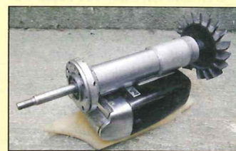
Obr. 25: Statické vyvažování s pomocí vibrací
