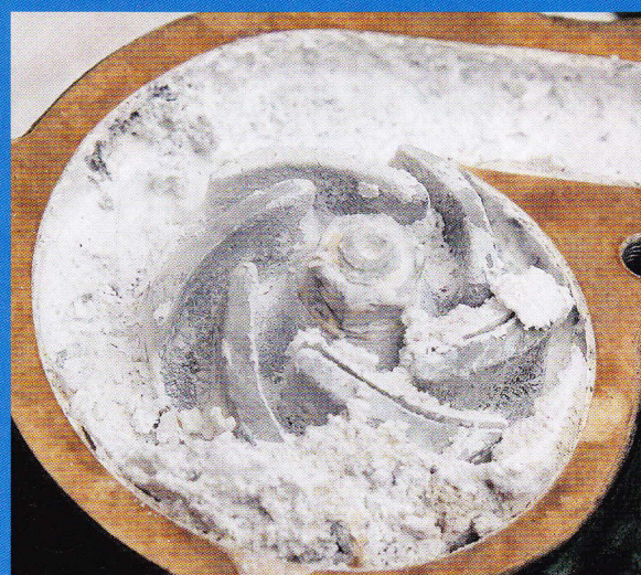
◀ Jen papírové těsnění jasně ohraničovalo prostor čerpadla chladicí kapaliny, plný produktů koroze hořčíku a hliníku
