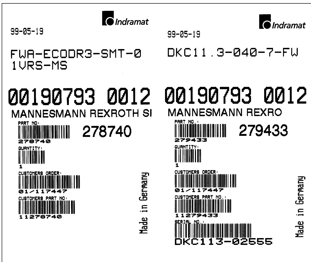
Abb. 13-1: Aufbau der Barcode-Aufkleber auf der Verpackung
