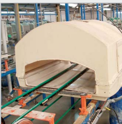
Zařízení na lazurování dlaždiček s kruhovým řemenem BEHAbelt PU 85 A zelený, Ø 15 mm
