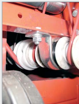
Válečkový pohon přes královský hřídel s odsunem řemene PU 75 A červený, Ø 6,3 mm a Ø 10 mm
