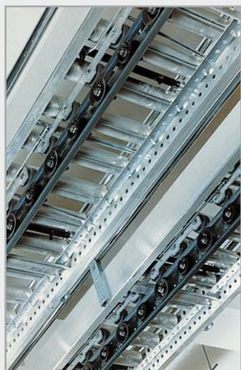
Sběrný válečkový dopravník, pohon přes spodní větev klínového řemene BEHAbelt, polyester 55 D, profil 17 x 11 mm
