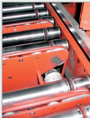
Válečkový pohon přes královský hřídel s odsunem řemene PU 75 A červený, Ø 6,3 mm a Ø 10 mm
