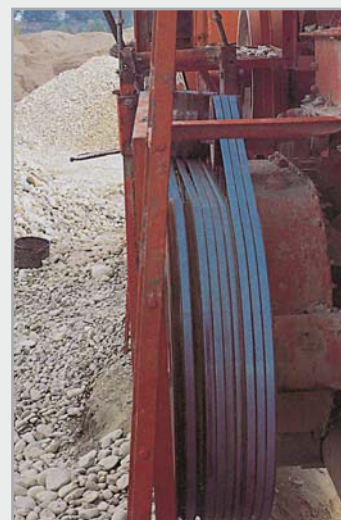
Drtič kamene s klínovým řemenem BEHAbelt, polyester 55 D, profil 22 x 14 mm
