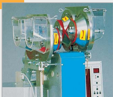
Plně automatický třídící stroj s dutým kruhovým řemenem BEHAbelt PU 75 A, Ø 6,3 mm
