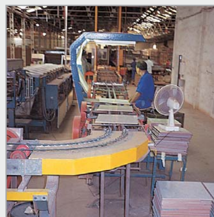
Zakřivený dopravník s kruhovým řemenem BEHAbelt PU 75 A, Ø 9,5 mm
