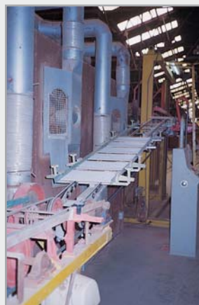
Doprava obkladaček se špičatým klínovým řemenem BEHAbelt PU 90 A, profil 22 x 24 mm
