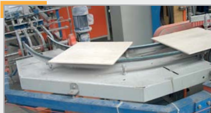
Zakřivený dopravník s kruhovým řemenem BEHAbelt PU 85 A zelený, Ø 15 mm
