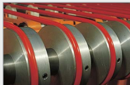
Lakovací zařízení s BEHAbelt PU 75 A Kruhový řemen, Ø 12,5 mm
