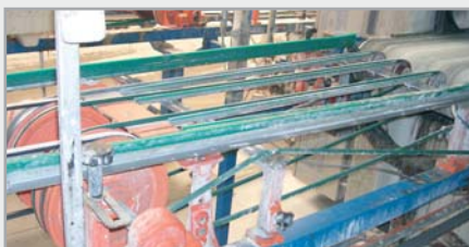
Dopravník obkladaček s kruhovým řemenem BEHAbelt PU 85 A zelený, Ø 15 mm
