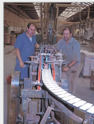
Zkušební chod dopravníku Předpětí: Polyester 55 D 2 % PU 75 A 6 %
