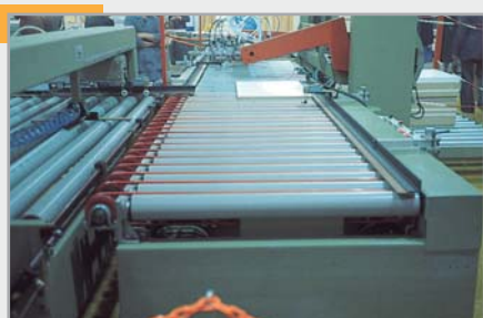
Doprava třískových desek pomocí BEHAbelt Klínový řemen PU 75 A, profil 17 x 11 mm
