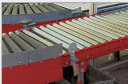
Válečkový dopravník s klínovým řemenem BEHAbelt, polyester 17 x 11 mm
