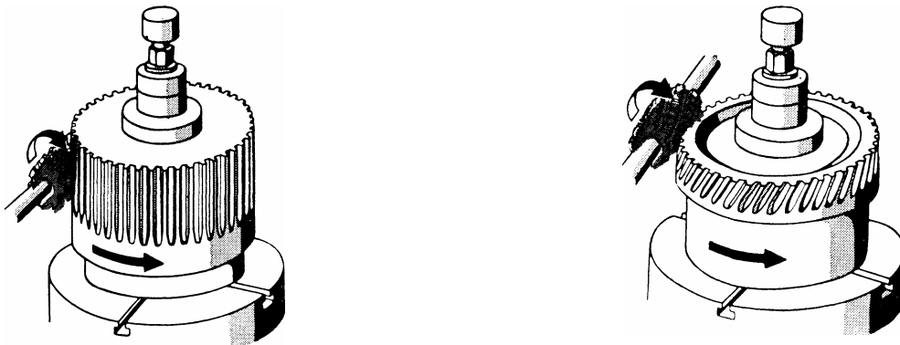
Obr. 216,3. Odvalovací frézování čelního kola přímými a se šikmými zuby
